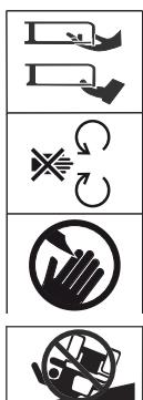
Verletzungsgefahr durch rotierende Messer oder Teile.
